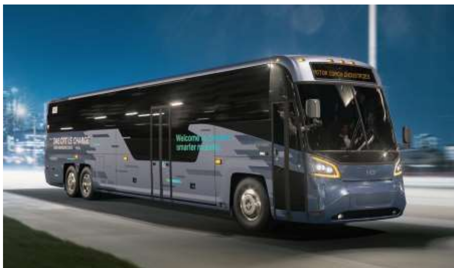
Εικόνα 3.5 Το D45 CRT LE CHARGE της MCI με μπαταρία 389 kWh και εύρος 300 χμ. χωρίς επαναφόρτιση (MCI, 2021)
