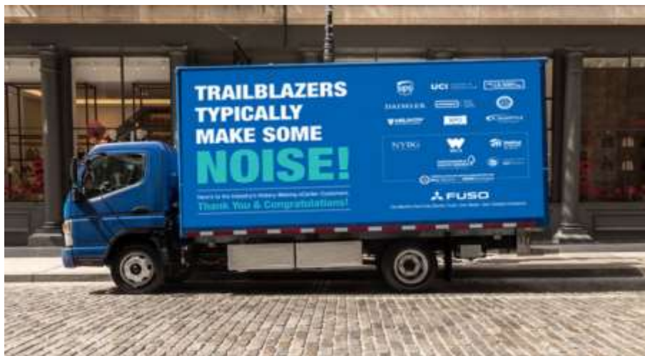
Εικόνα 3.4 Το Mitsubishi FUSO eCANTER με μπαταρία χωρητικότητας 82,5 kWh χρόνο φόρτισης 8 ώρες με AC και εύρος χωρίς επαναφόρτιση 130 χλμ.
